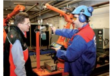
Tuotantopäällikkö Jari Pulkkinen ja Atlas Copcon Lujabetonin yhteyshenkilö Jukka Mauranen tarkistavat mittaamalla ettei Lujabetonin uuden huippumodernin maatalouselementtitehtaan hitsausrobotissa ole paineilma- ja -laitteiden vuotoja. Oikealla kuvassa paineilmakompressorit.
