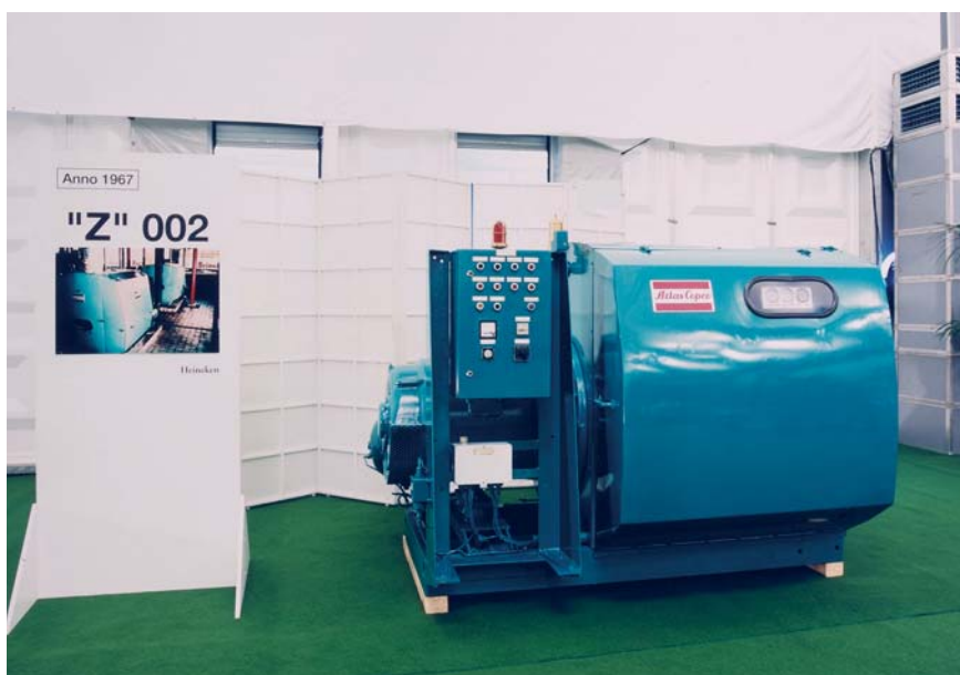
Z - 002 Pack - Heineken unit - 1. öljytön Z-Pack kompressorimalli - 1967
